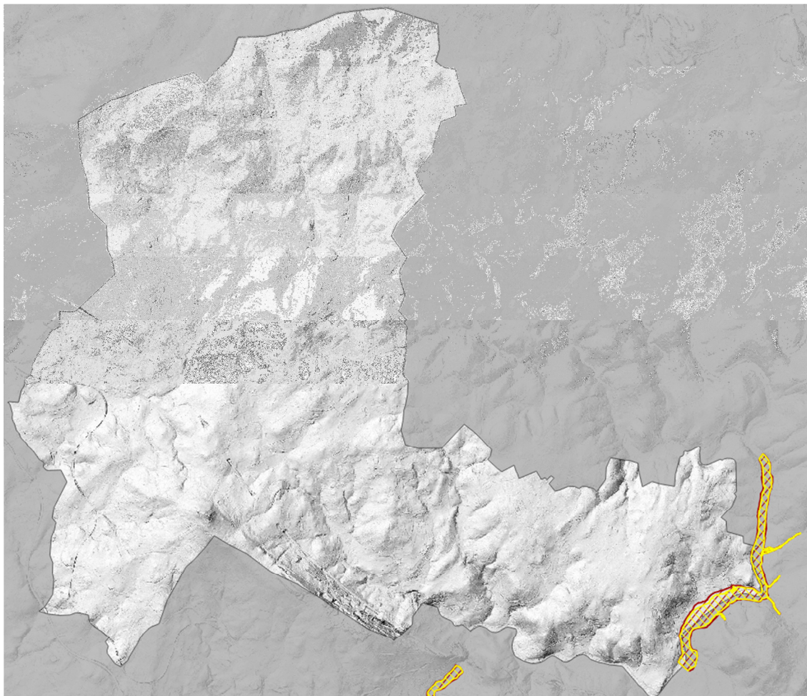
Figura 9: Delimitación das zonas inundables para os períodos de retorno T100 (amarelo) e T500 (granate). (Xunta de Galicia)
